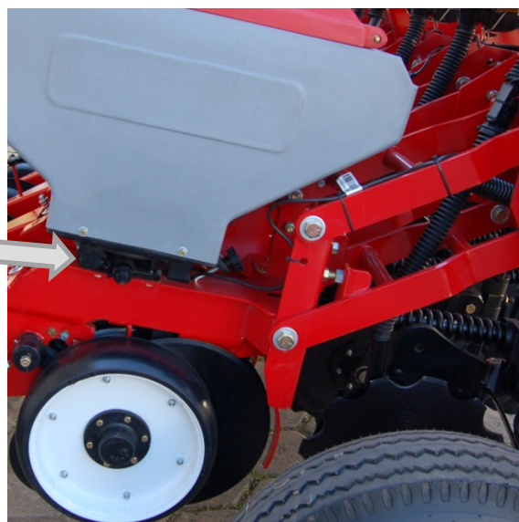
Dosificador A Placa mecánica
